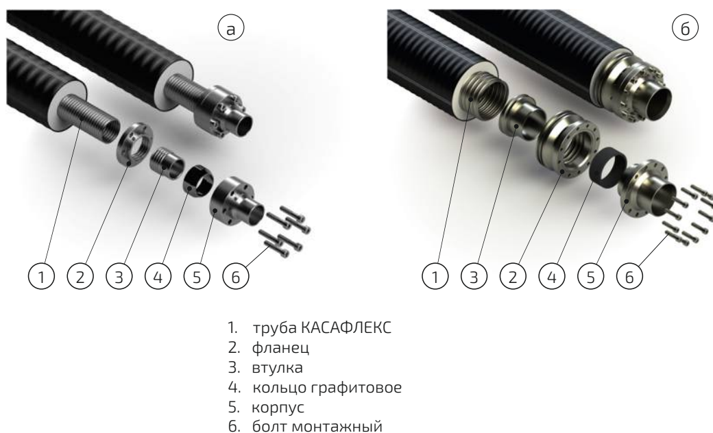
Рис. 1.2.1 Конструкция фитинга концевое под сварку а) типоразмеры от 55 до 109; б) типоразмеры от 143 до 163
